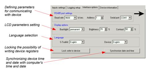
Fig. 3.4. Interface options tab functions
